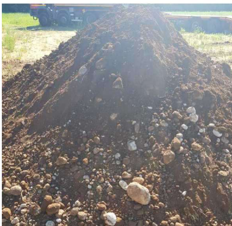
FOTO 4: Particolare del materiale rilevato nel pozzetto geognostico P1.
