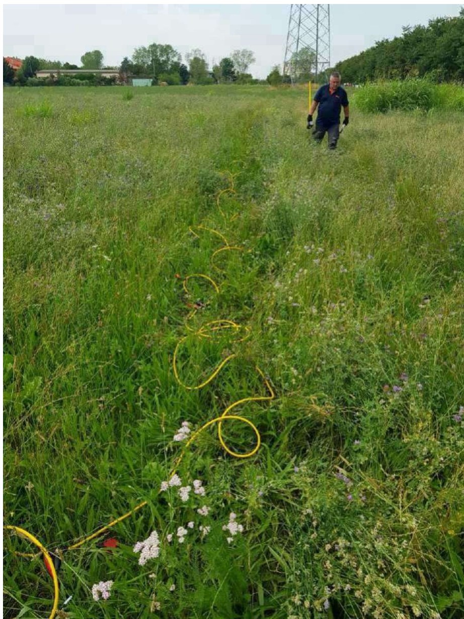
FOTO 7: Particolare dello stendimento di geofisica.
